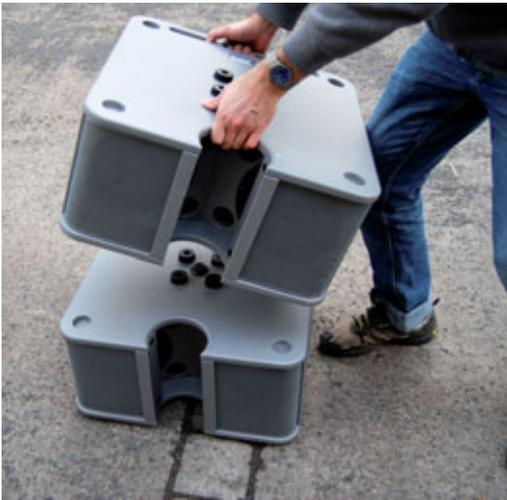
Abb 5: Die System-Subwoofer mit 2 x 8-Zoll-Bestückung werden übereinandergestapelt, wobei der bekannte Systemverbinder die elektrische Verbindung herstellt; die spezielle Anordnung der GummifüÙe um den Verbinder stellt sicher, dass eine ähnliche Verbinderrplatte mit PowerCon-Buchsen rein mechanisch erst gar keinen (unbeabsichtigten) Anschluss erhält
