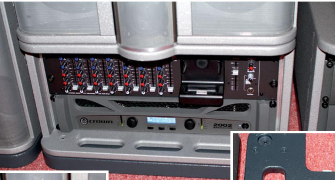
**Abb. 5:** 19-Zoll-Rack-Bauteil, frei bestückbar mit der gewünschten Endstufe und zusätzlichem Equipment wie Power-Mixer, Effektgerät oder Drahtlos-Technik
