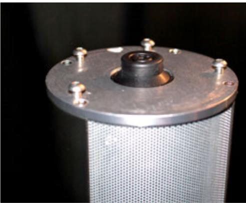
**Abb. 8:** Die vier Bajonettbolzen dienen zum Verbinden eines weiteren Säulenelements, der Steckkontakt überträgt das Lautsprecher-Audiosignal; alternativ bedeckt ein Abschlussdeckel die Säule
